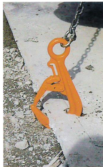
▲ 敷鉄板移動作業に SH-2型(2.5t)
